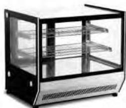
**VITRINA EXHIBIDORA CALIENTE PARA MOSTRADOR DE CRISTALES RECIOS MARCA MIGSA,** FABRICADA EN ACERO INOXIDABLE TIPO 201 EN ACABADOS ESPEJO Y CRISTAL, CAPACIDAD DE 140 L, TEMPERATURA DE 40-65°C., 2 PUERTAS POSTERIORES DESLIZABLES, 2 PARRILLAS CROMADAS. VOLTAJE: 110 - 120V / 60 HZ, POTENCIA 460 WATTS. DIMENSIONES: 900 X 530 X 730 MM. | CÓDIGO SA# 48102102
