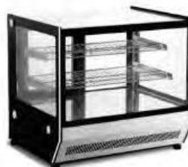
**VITRINA EXHIBIDORA CALIENTE PARA MOSTRADOR DE CRISTALES RECIOS MARCA MIGSA,** FABRICADA EN ACERO INOXIDABLE TIPO 201 EN ACABADOS ESPEJO Y CRISTAL, CAPACIDAD DE 190 L, TEMPERATURA DE 40-65°C., 2 PUERTAS POSTERIORES DESLIZABLES, 2 PARRILLAS CROMADAS. VOLTAJE: 110-120V/60HZ, POTENCIA 910 WATTS. DIMENSIONES: 1200 X 530 X 730 MM. | CÓDIGO SA# 48102102
