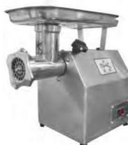
**MOLINO P/CARNE COMERCIAL DE 1.1 HP MARCA MIGSA.** CON MOTOR DE 850 WATT'S (1.1 H.P.) CAPACIDAD DE 160 A 180 KGS PORHORA, FUNCIÓN DE ENGRANES, CONPROTECCIÓN TÉRMICA, GABINETE Y CHAROLA DE ACERO INOXIDABLE DE GRAN RESISTENCIA, CABEZAL DEL NO. 12, INCLUYE NAVAJA Y CEDAZO DE REPUESTO
