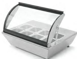
**BASE CALIENTE ELÉCTRICA DE 8 INSERTOS DE SOBRE MESA CON TAPA MARCA MIGSA,** FABRICADO EL GABINETE EN ACERO INOXIDABLE TAPA DE CRISTAL ABATIBLE CON DESCANSO, 8 INSERTOS SEXTOOS DE 10 CM DE FONDO INCLUIDOS, EQUIPO DE CALEFACCIÓN CON RESISTENCIA DE 500 W, TEMPERATURA DE 30 A 90°C, CONTROL DE TEMPERATURA DIGITAL CON INTERRUPTOR MANUAL, TIPO SOBRE MESA, CON CORRIENTE A 110 VOLTS, 60 CICLOS. PESO NETO: 17.5 KG. MEDIDAS: 767 X 612 X 328 MM. | CÓDIGO SA# 48102102
