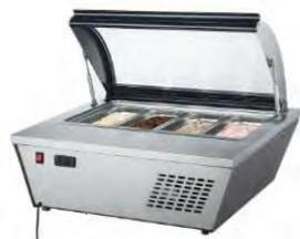
**BASE CONGELADA PARA HELADOS DE 4 INSERTOS SOBRE MESA CON TAPA MARCA MIGSA**, FABRICADO EL GABINETE EN ACERO INOXIDABLE TAPA DE CRISTAL ABATIBLE CON DESCANSO, 4 INSERTOS TERCIOS DE 10 CM DE FONDO INCLUIDOS, EQUIPO DE CONGELACIÓN CON TEMPERATURA AJUSTABLE DE -18 A -25°C, CONTROL DE TEMPERATURA DIGITAL CON INTERRUPTOR MANUAL, TIPO SOBRE MESA, CON CORRIENTE A 110 VOLTS, 60 CICLOS. PESO NETO DE 38 KG.
