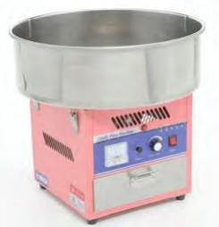
**FÁBRICADORA DE ALGODONES DE AZÚCAR MARCA MIGSA.** FABRICADORA CON CAPACIDAD DE 4 A 6 ALGODONES POR MINUTO, FABRICADO EL GABINETE EN LÁMINA ESMALTADA Y EL TAZÓN EN ACERO INOXIDABLE, CAJÓN CON MEDIDOR Y DIVISIONES PARA EL AZÚCAR, POTENCIA DE RESISTENCIA DE 950 WATTS Y EL MOTOR DE 80 WATTS A 120 VOLTS, 60 CICLOS, PESO BRUTO 14.5 KGS., PESO NETO 13 KGS. **MEDIDAS: 520 X 520 X 440 MM.**
