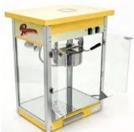
**FÁBRICADORA DE PALOMITAS ELÉCTRICA DE 8 ONZAS (250 GRS.) MARCA MIGSA.** GABINETE EN LÁMINA ESMALTADA Y PISO INTERIOR EN ACERO INOXIDABLE, OLLA DE ACERO INOXIDABLE CON TEFLÓN, CAPACIDAD DE 8 ONZAS, POTENCIA DE 1.5 KW. A 120 V / 60HZ, LUZ INTERIOR PARA ILUMINACIÓN, RESISTENCIA INFERIOR PARA MANTENER CALIENTES LAS PALOMITAS. **MEDIDAS: 520 X 400 X 670 MM.**
