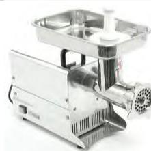
**MOLINO DE CARNE COMERCIAL 1.5 H.P. MARCA MIGSA.** FABRICADO EL CUERPO EN ACERO INOXIDABLE TIPO 304., CABEZAL EN FUNDICIÓN DE ACERO INOXIDABLE DEL No.32, MOTOR DE 1,100 W (1.5 H.P.) A 110 V / 60 CICLOS, BOTÓN DE ENCENDIDO Y APAGADO, PESO BRUTO 27.7 KGS., PESO NETO 25.5 KGS. **MEDIDAS: 645 X 305 X 500 M.**
