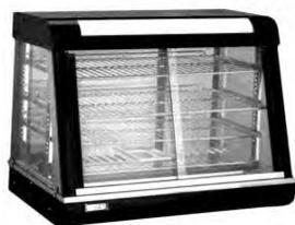
**VITRINA CALIENTE SOBRE MOSTRADOR MARCA MIGSA.** GABINETE ESMALTADO, PISO INTERIOR EN ACERO INOXIDABLE, CRISTALES RECIOS CON PUERTAS DESLIZABLES AL FRENTE Y PARTE POSTERIOR, CUBIERTA EN ACERO INOXIDABLE, 3 NIVELES DE ACOMODO DE PRODUCTOS Y EXHIBICIÓN, CONTROL DE TEMPERATURA AJUSTABLE DE 30 A 90°C. TERMÓMETRO AL FRENTE, INDICADOR DE TEMPERATURA. POTENCIA DE 1840W A 110V/60HZ. PESO NETO 33 KGS. MEDIDAS: 600 x 450 x 590 MM. | CÓDIGO SA# 48102102
